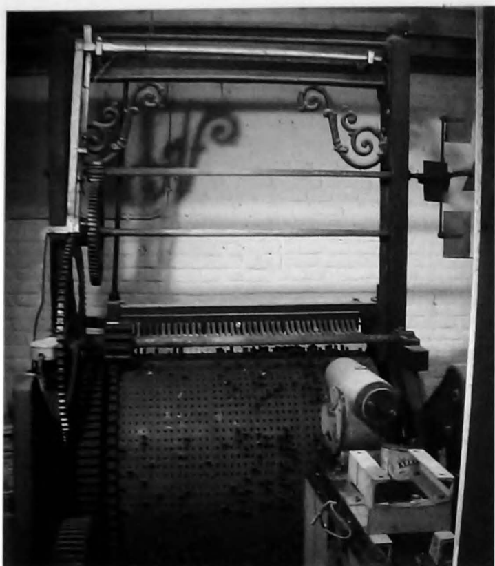
De oude mechanische trommel om de beiaard automatisch te laten spelen staat nog steeds als een museumstuk onder de klavierkamer
