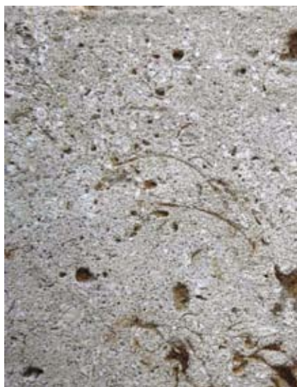
Detail van een Ledesteen aan het voormalige molenaarshuis in de Molenstraat. De kleine nummulieten en een aantal schelpgeesten zijn duidelijk zichtbaar.
